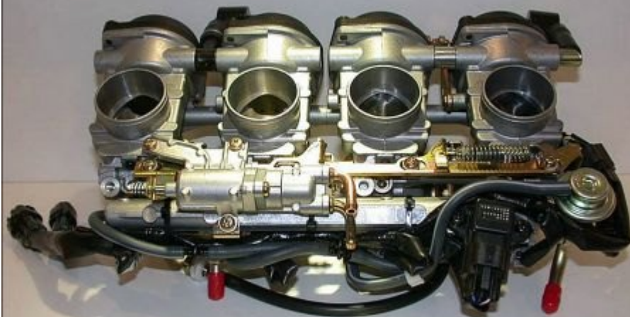
Vstříkovací tělesa (4 válec) s podtlakově ovládaným přísunem vzduchu pomocí šoupátka na membráně
